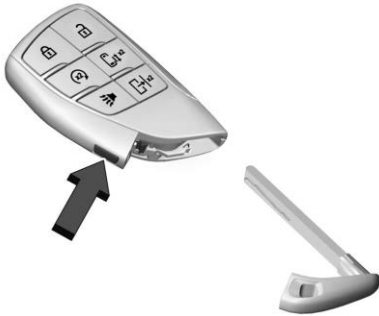
La llave mecánica dentro de la llave remota se usa para la puerta trasera.
